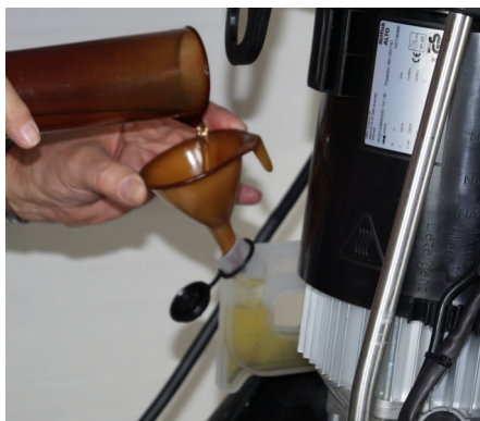
Pompolietaank met oliepeilglas en vullen/leggen functie.
