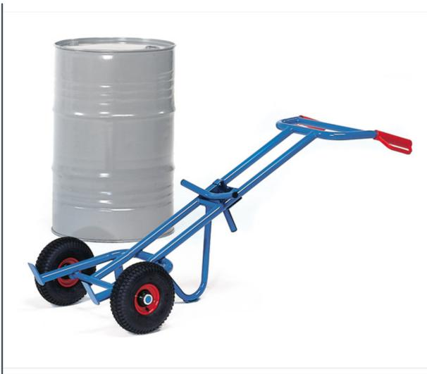
Stahlrohr geschweißt, pulverbeschichtet, blau RAL 5007, dauerhaft oberflächengeschützt. Räder mit Luftbereifung, Naben mit Rollenlager. Für alle 200-Liter-Fässer mit Rand geeignet.
