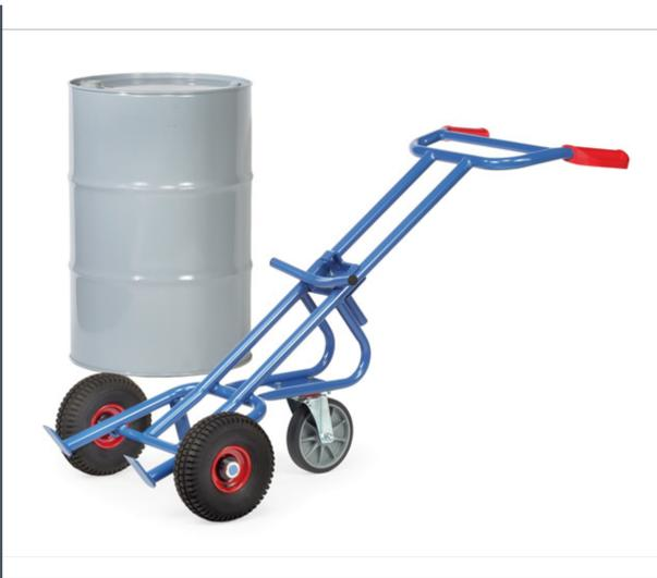
Stahlrohr geschweißt, pulverbeschichtet, blau RAL 5007, dauerhaft oberflächengeschützt. Räder mit Vollgummibereifung, Naben mit Rollenlager. Für alle 200-Liter-Fässer mit Rand geeignet. Zusätzlich mit 1 Stütz-Lenkrolle TPE 200 x 40 mm.
