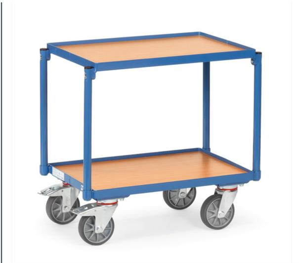
Mit 2 Plattformen. Beide Rahmen mit Böden aus Holzwerkstoffplatte, Oberfläche Buchendekor, Rand 15 mm hoch. Pulverbeschichtet blau RAL 5007. Lichter Etagenabstand 400 mm, Gesamthöhe 639 mm. Tragkraft obere Ladefläche 100 kg. 4 Lenkrollen mit TPE-Bereifung, Naben mit Rillenkugellager. 2 Stück mit Feststeller, gemäß der Europäischen Norm EN 1757-3 (Sicherheit von Plattformwagen). Passend für Eurokästen 600 x 400 mm. Zerlegte Anlieferung.
