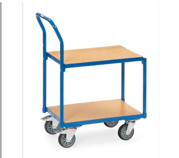
Mit 2 Plattformen und Rohrschiebebügel. Beide Rahmen mit Böden aus Holzwerkstoffplatte, Oberfläche Buchendekor. Böden bündig mit Oberkante Rahmen. Pulverbeschichtet blau RAL 5007. Lichter Etagenabstand 400 mm, Gesamthöhe 970 mm. Tragkraft obere Ladefläche 100 kg. 4 Lenkrollen mit TPE-Bereifung, Naben mit Rillenkugellager. 2 Stück mit Feststeller, gemäß der Europäischen Norm EN 1757-3 (Sicherheit von Plattformwagen). Passend für Eurokästen 600 x 400 mm. Zerlegte Anlieferung.
