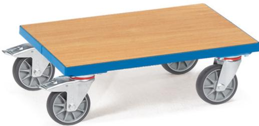
Winkelstahlkonstruktion mit Boden aus Holzwerkstoffplatte, bündig im Rahmen liegend. Pulverbeschichtet blau RAL 5007. 4 Lenkrollen mit TPE-Bereifung, Naben mit Rillenkugellager. 2 Stück mit Feststeller, gemäß der Europäischen Norm EN 1757-3 (Sicherheit von Plattformwagen). Passend für Eurokästen 600 x 400 mm.
