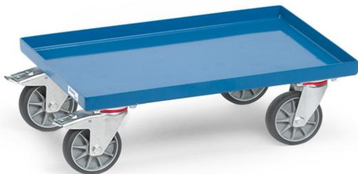
Winkelstahlkonstruktion mit Stahlblechwanne. Besonders geeignet für den Transport von durchbrochenen Kästen mit öligen oder feuchten Teilen. Es tropft nichts auf den Boden. Wanne dicht verschweißt, pulverbeschichtet blau RAL 5007. Rand 22 mm hoch. 4 Lenkrollen mit TPE-Bereifung, Naben mit Rillenkugellager. 2 Stück mit Feststeller, gemäß der Europäischen Norm EN 1757-3 (Sicherheit von Plattformwagen).
