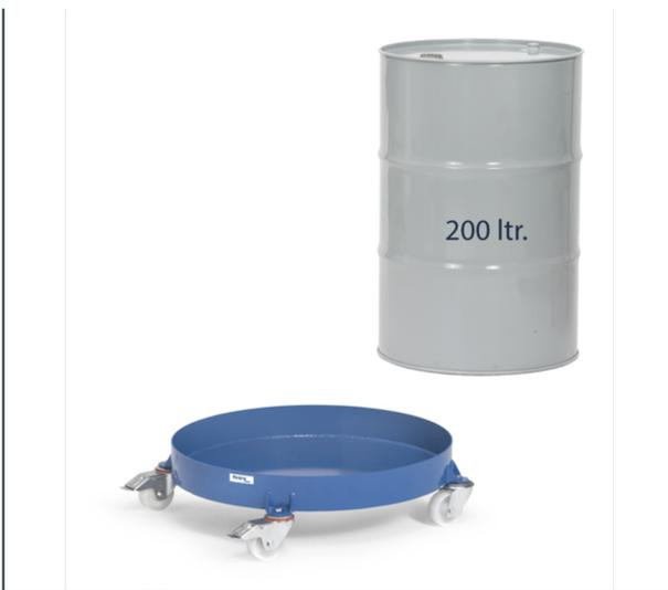
Für stehenden Transport von Stahlblech-Fässern mit 200 Litern Inhalt. Verschweißte Stahlkonstruktion, pulverbeschichtet brillantblau RAL 5007. Stahlblechwanne, öldicht verschweißt. Innen-Ø 630 mm. Rand 80 mm hoch. 4 Lenkrollen, 2 Stück mit Feststeller, Räder Polyamid, Naben mit Gleitlagerung.
