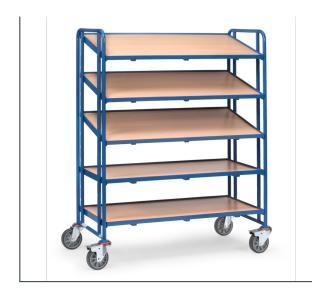
Baukasten-System: Stahlrohr und Profilstahl geschweißt, pulverbeschichtet blau RAL 5007, Schraubkonstruktion. Variabel einschraubbare Etagen, Raster 100 mm, Neigung bei schrägem Einbau 15° oder 30°. Tragkraft pro Ladefläche 80 kg. 5 Etagenrahmen passend für je 3 Eurokästen 600x400 mm. 4 Lenkrollen, TPE-Bereifung, Naben mit Rillenkugellager. 2 Stück mit Feststeller, gemäß der Europäischen Norm EN 1757-3 (Sicherheit von Plattformwagen).
