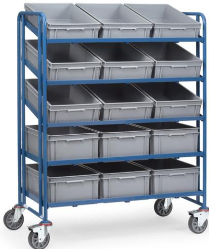
Baukasten-System: Stahlrohr und Profilstahl geschweißt, pulverbeschichtet blau RAL 5007, Schraubkonstruktion. Variabel einschraubbare Etagen, Raster 100 mm, Neigung bei schrägem Einbau 15° oder 30°. Tragkraft pro Ladefläche 80 kg. 5 Etagenrahmen passend für je 3 Eurokästen 600x400 mm. 4 Lenkrollen, TPE-Bereifung, Naben mit Rillenkugellager. 2 Stück mit Feststeller, gemäß der Europäischen Norm EN 1757-3 (Sicherheit von Plattformwagen).
