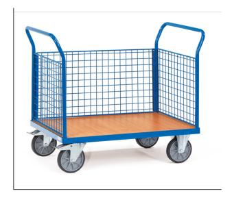
Stahlrohr und Profilstahl geschweißt, pulverbeschichtet RAL 5007, Plattform Holzwerkstoffplatte, Oberfläche Buchendekor. 2 Stirnwände und 1 Längswand aus Drahtgitter 50 x 50 x 4 mm, Wände 500 mm hoch. 2 Lenkund 2 Bockrollen, TPE-Bereifung, Naben mit Rillenkugellager. Feststeller an den Lenkrollen, gemäß der Europäischen Norm EN 1757-3 (Sicherheit von Plattformwagen).
