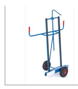
Stahlrohr-Konstruktion mit Stahlblechschaufel, Anlagen mit Profilgummi belegt (rutschsicher), und einstellbarem Niederhalter als Kippsicherung. Pulverbeschichtet blau RAL 5007. Räder wahlweise mit Vollgummi- oder Luft-Bereifung. Naben mit Rollenlager. 2 Stützrollen 50 mm Ø. Zerlegte Anlieferung. Zum Längstransport von großflächigen Holzund Kunststoffplatten.
