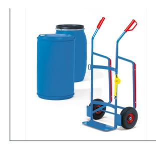
Für den Transport von Kunststoff-Fässern 120-220 Liter Inhalt. Stahlrohr geschweißt, pulverbeschichtet, blau RAL 5007, dauerhaft oberflächengeschützt. Räder wahlweise mit Vollgummi- oder Luftbereifung, Naben mit Rollenlager. Spanngurt zur Fass-Sicherung.
