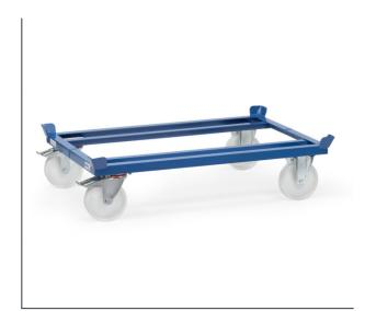
Für Flachpaletten und Gitterboxen. Robuste Winkelstahl-Schweißkonstruktion, mit 4 Fangecken, pulverbeschichtet, blau RAL 5007. 2 Lenk- und 2 Bockrollen, Polyamid-Räder, Naben mit Rollenlager, Feststeller an den Lenkrollen, gemäß der europäischen Norm EN 1757-3 (Sicherheit von Plattformwagen). Geringer Rollwiderstand, hohe chemische Beständigkeit, nicht kreidend = spurlos. Fahrgeräusche.
