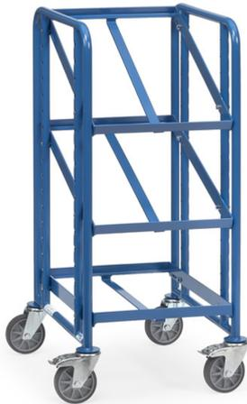
Stahlrohr und Profilstahl-Konstruktion, pulverbeschichtet RAL 5007. Schraubkonstruktion. Etagenrahmen variabel einschraubbar, Raster 50 mm, Neigung bei schrägem Einbau 15° oder 30°. Tragkraft obere und mittlere Ladefläche 60 kg. 3 Etagenrahmen passend für je 1 Eurokasten. 4 Lenkrollen, TPE-Bereifung, Naben mit Rillenkugellager. 2 Stück mit Feststeller, gemäß der Europäischen Norm EN 1757-3 (Sicherheit von Plattformwagen).
