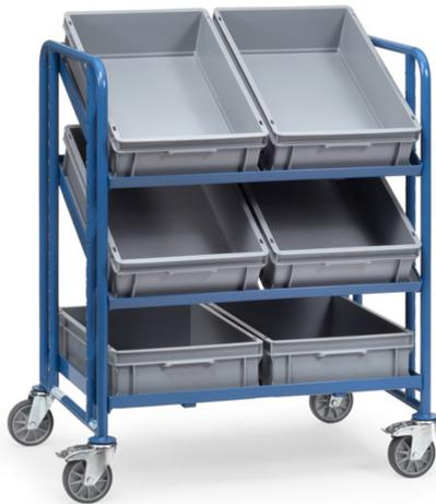
Stahlrohr und Profilstahl-Konstruktion, pulverbeschichtet RAL 5007. Schraubkonstruktion. Offene Etagenrahmen variabel einschraubbar, Raster 50 mm, Neigung bei schrägem Einbau 15° oder 30°. Tragkraft obere und mittlere Ladefläche 60 kg. Mit 3 Eurokästen 600 x 400 x 145 mm. 4 Lenkrollen, TPE-Bereifung, Naben mit Rillenkugellager. 2 Stück mit Feststeller, gemäß der Europäischen Norm EN 1757-3 (Sicherheit von Plattformwagen).
