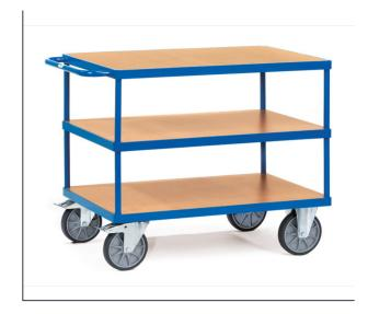
Stahlrohr und Profilstahl geschweißt, pulverbeschichtet RAL 5007. 3 Plattformen aus Holzwerkstoffplatte, Oberfläche Buchendekor. 2 Lenk- und 2 Bockrollen, TPE-Bereifung, Naben mit Rillenkugellager. Feststeller an den Lenkrollen, gemäß der Europäischen Norm EN 1757-3 (Sicherheit von Plattformwagen). Tragkraft obere und mittlere Ladefläche 200 kg.
