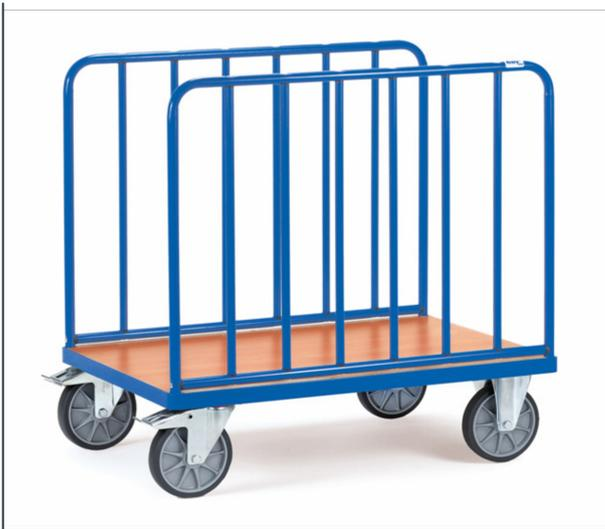
Stahlrohr und Profilstahl geschweißt, pulverbeschichtet RAL 5007, Plattform Holzwerkstoffplatte, Oberfläche Buchendekor. Mit 2 Rohrbügeln mit vertikalen Streben im Abstand ca. 130 mm. 2 Lenk- und 2 Bockrollen, TPE-Bereifung, Naben mit Rillenkugellager. Feststeller an den Lenkrollen, gemäß der Europäischen Norm EN 1757-3 (Sicherheit von Plattformwagen).
