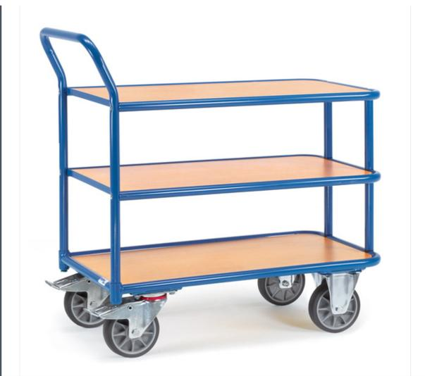
Profilstahl-/Stahlrohr-Schweißkonstruktion, pulverbeschichtet, blau RAL 5007. 3 Böden aus Holzwerkstoffplatte, Oberfläche Buchendekor. 2 Lenk- und 2 Bockrollen, TPE-Bereifung, Naben mit Rillenkugellager. Feststeller an den Lenkrollen, gemäß der Europäischen Norm EN 1757-3 (Sicherheit von Plattformwagen).
