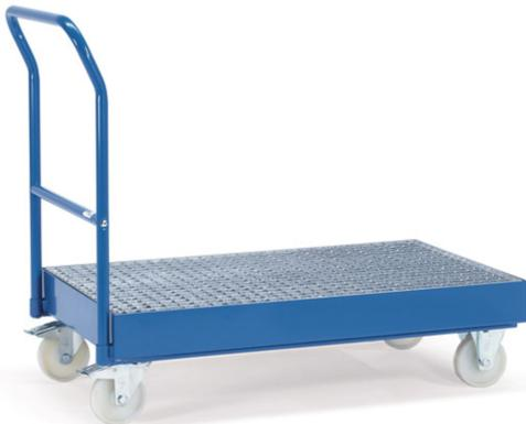
Stahl-Konstruktion geschweißt, Wanne 100 mm hoch, öldicht, pulverbeschichtet blau RAL 5007. Mit bündig eingelegtem Gitterrost, Maschenweite 31 x 31 mm, feuerverzinkt. 2 Lenk- und 2 Bockrollen, Naben mit Rollenlagerung. Feststeller an den Lenkrollen, gemäß der Europäischen Norm EN 1757-3 (Sicherheit von Plattformwagen). Zum Transport von 1 oder 2 200-Liter-Fässer geeignet. Verhindert Schäden durch Tropföl. Auffangwanne 45 Liter.
