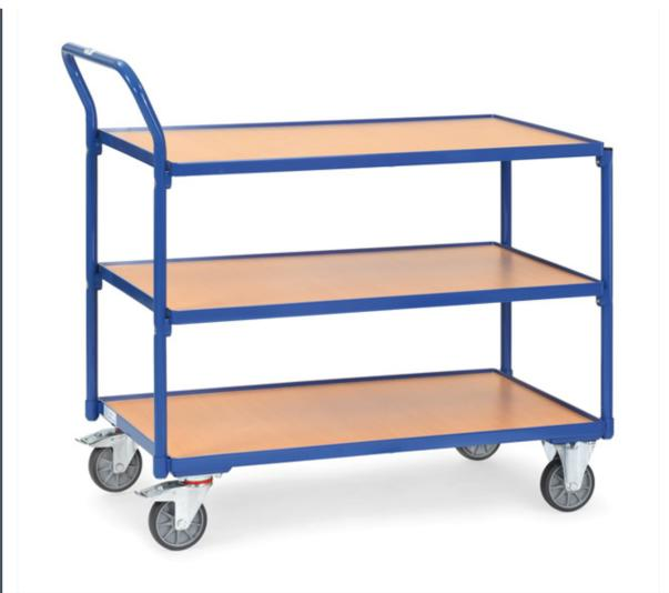
Stahlrohr und Profilstahl geschweißt, pulverbeschichtet. Schraubkonstruktion. 3 Böden aus Holzwerkstoffplatte, Oberfläche Buchendekor, im Stahlrahmen liegend, Rand 12 mm hoch. Schiebegriff hochstehend. 2 Lenk- und 2 Bockrollen, TPE-Bereifung, Naben mit Rillenkugellager. Feststeller an den Lenkrollen, gemäß der Europäischen Norm EN 1757-3 (Sicherheit von Plattformwagen). Tragkraft obere und mittlere Ladefläche 80 kg.
