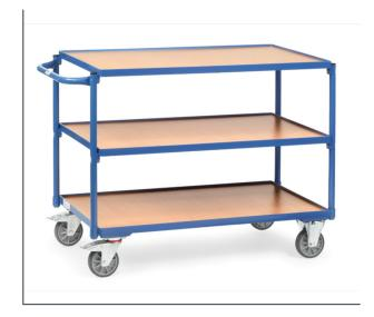
Stahlrohr und Profilstahl geschweißt, pulverbeschichtet. Schraubkonstruktion. 3 Böden aus Holzwerkstoffplatte, Oberfläche Buchendekor, im Stahlrahmen liegend, Rand 12 mm hoch. Schiebegriff waagerecht. 2 Lenk- und 2 Bockrollen, TPE-Bereifung, Naben mit Rillenkugellager. Feststeller an den Lenkrollen, gemäß der Europäischen Norm EN 1757-3 (Sicherheit von Plattformwagen). Tragkraft obere und mittlere Ladefläche 80 kg.
