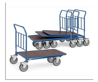
Stahlrohrkonstruktion, pulverbeschichtet, Ladefläche: rutschsichere Siebdruckplatte aus wasserfestem Sperrholz. 2 Lenk- und 2 Bockrollen, TPE-Bereifung, Naben mit Rillenkugellager. Feststeller an den Lenkrollen, gemäß der Europäischen Norm EN 1757-3 (Sicherheit von Plattformwagen). Ineinanderschiebbare Wagen, 75% Stellraum-Einsparung. Gesamtbreite: 650 mm.
