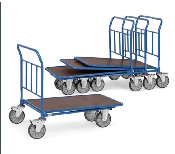
Stahlrohrkonstruktion, pulverbeschichtet, Ladefläche: rutschsichere Siebdruckplatte aus wasserfestem Sperrholz. 2 Lenk- und 2 Bockrollen, TPE-Bereifung, Naben mit Rillenkugellager. Feststeller an den Lenkrollen, gemäß der Europäischen Norm EN 1757-3 (Sicherheit von Plattformwagen). Ineinanderschiebbare Wagen, 75% Stellraum-Einsparung. Gesamtbreite: 850 mm.
