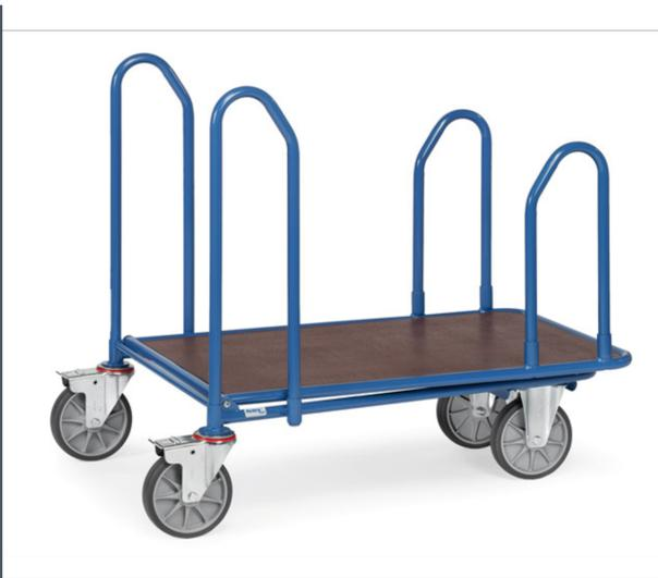
Stahlrohrkonstruktion, pulverbeschichtet, Ladefläche: rutschsichere Siebdruckplatte aus wasserfestem Sperrholz. Mit 2 Seitenbügeln 680 mm hoch und 2 Seitenbügeln (an der Bockrollenseite) 500 mm hoch 2 Lenk- und 2 Bockrollen, TPE-Bereifung, Naben mit Rillenkugellager. Feststeller an den Lenkrollen, gemäß der Europäischen Norm EN 1757-3 (Sicherheit von Plattformwagen). Ineinanderschiebbare Wagen, 75% Stellraum-Einsparung. Lichte Ladeflächenbreite: 435 mm.
