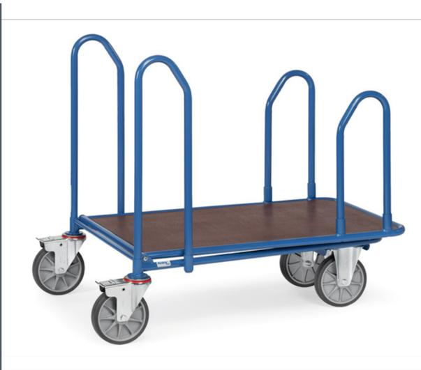
Stahlrohrkonstruktion, pulverbeschichtet, Ladefläche: rutschsichere Siebdruckplatte aus wasserfestem Sperrholz. Mit 2 Seitenbügeln 680 mm hoch und 2 Seitenbügeln (an der Bockrollenseite) 500 mm hoch 2 Lenk- und 2 Bockrollen, TPE-Bereifung, Naben mit Rillenkugellager. Feststeller an den Lenkrollen, gemäß der Europäischen Norm EN 1757-3 (Sicherheit von Plattformwagen). Ineinanderschiebbare Wagen, 75% Stellraum-Einsparung. Lichte Ladeflächenbreite: 535 mm.
