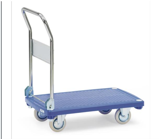
Plattformen aus Kunststoff gespritzt mit rutschhemmender Oberfläche. Rohrschiebebügel klappbar, mit breiter Querstrebe und Klappgelenk, glanzverzinkt. 2 Lenk- und 2 Bockrollen, Vollgummibereifung blaugrau spurlos. Feststeller an den Lenkrollen, gemäß der Europäischen Norm EN 1757-3. Zerlegte Anlieferung.
