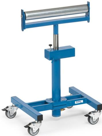
Zur Unterstützung von Langmaterialien an Sägen, Pressen Bohrmaschinen usw. Stufenlos höhenverstellbar, dreh- und arretierbar, mit pneumatischer Absenkämpfung. Fahrbar. Auflagerolle aus Stahlrohr 60 mm ø, kugelgelagert. Beidseitig Schwerkraftanschläge 20 mm über Oberkante Rolle (drehen sich bei breiten Werkstücken selbsttätig weg). 4 Lenkrollen mit Feststeller.
