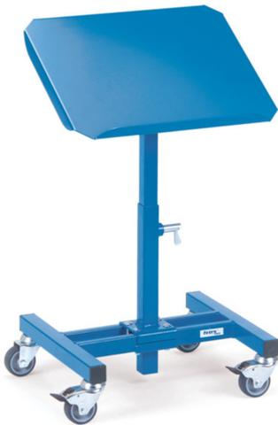
Für Kunststoffkästen, Stahlblechkästen, Drahtkörbe usw., höhenverstellbar und fahrbar. Profilstahl-/Rohrkonstruktion mit Stahlblechplattform. Stahlblechplattform mit einseitiger Anlegekante, neigbar um 15° und 30°, höhenverstellbar im Raster von 25 mm. Pulverbeschichtet blau RAL 5007. 4 Lenkrollen, Naben mit Gleitlagerung, 2 davon mit Feststeller gemäß der Europäischen Norm EN 1757-3 (Sicherheit von PI 3280: 505 - 775 mm höhenverstellbar
