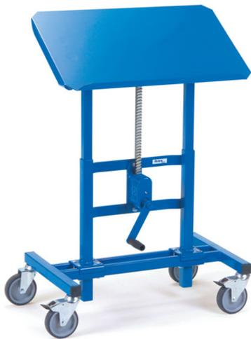
Für Kunststoffkästen, Stahlblechkästen, Drahtkörbe usw., höhenverstellbar und fahrbar. Profilstahl-/Rohrkonstruktion mit Stahlblechplattform. Plattform mit einseitiger Anlegekante, neigbar um 15° und 30°, stufenlos höhenverstellbar mittels Zahnstangenwinde, auch unter Last möglich. 2 Teleskopsäulen. Pulverbeschichtet blau RAL 5007. 4 Lenkrollen, Naben mit Gleitlagerung, 2 davon mit Feststeller gemäß der Europäischen Norm EN 1757-3 (Sicherheit von Plattformwagen).
