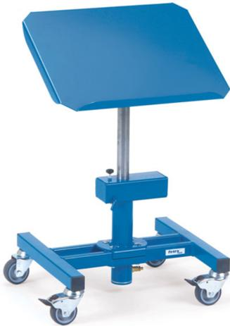
Für Kunststoffkästen, Stahlblechkästen, Drahtkörbe usw., höhenverstellbar und fahrbar. Profilstahl-/Rohrkonstruktion mit Stahlblechplattform. Plattform mit einseitiger Anlegekante, neigbar um 15° und 30°, stufenlos höhenverstellbar, dreh- und arretierbar, mit pneumatischer Absenkämpfung. Pulverbeschichtet blau RAL 5007. 4 Lenkrollen, Naben mit Gleitlagerung, 2 davon mit Feststeller gemäß der Europäischen Norm EN 1757-3 (Sicherheit von Plattformwagen).
