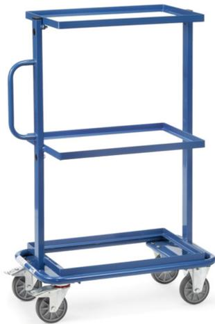
Stahlrohr- und Profilstahl-Konstruktion, pulverbeschichtet, blau RAL 5007. 3 offene Rahmen, ohne Platte. 2 Lenk- und 2 Bockrollen, TPE-Bereifung, Naben mit Rillenkugellager. Feststeller an den Lenkrollen, gemäß der Europäischen Norm EN 1757-3 (Sicherheit von Plattformwagen). Tragkraft obere und mittlere Ladefläche 50 kg.
