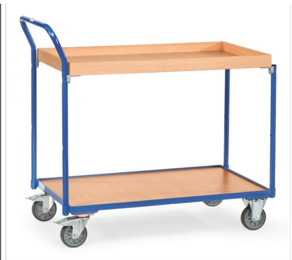
Stahlrohr und Profilstahl geschweißt, pulverbeschichtet. Schraubkonstruktion. 1 Boden mit 12 mm hohem Rand und 1 Kasten mit 45 mm hohem Rand. Aus Holzwerkstoffplatte, Oberfläche Buchendekor. Schiebegriff hochstehend. 2 Lenk- und 2 Bockrollen, TPE-Bereifung, Naben mit Rillenkugellager. Feststeller an den Lenkrollen, gemäß der Europäischen Norm EN 1757-3 (Sicherheit von Plattformwagen). Tragkraft obere und mittlere Ladefläche 80 kg.
