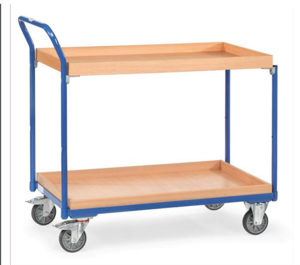
Stahlrohr und Profilstahl geschweißt, pulverbeschichtet. Schraubkonstruktion. 2 Kästen mit 45 mm hohem Rand. Aus Holzwerkstoffplatte, Oberfläche Buchendekor. Schiebegriff hochstehend. 2 Lenk- und 2 Bockrollen, TPE-Bereifung, Naben mit Rillenkugellager. Feststeller an den Lenkrollen, gemäß der Europäischen Norm EN 1757-3 (Sicherheit von Plattformwagen). Tragkraft obere und mittlere Ladefläche 80 kg.
