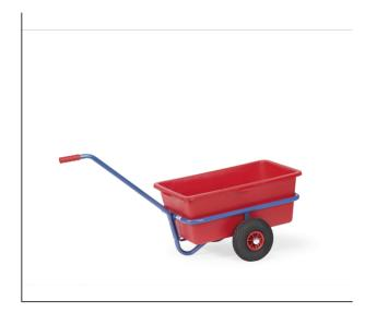
Leichter Handwagen aus Stahlrohr geschweißt, pulverbeschichtet blau RAL 5007. Deichsel anschraubbar. Mit roter Kunststoffmulde (90 bzw. 200 Liter Inhalt). Wahlweise Räder mit Vollgummi- oder Luftbereifung, Naben mit Rollenlager. Zerlegte Anlieferung. Leichte Selbstmontage.
