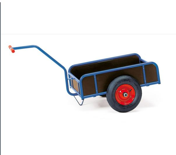
Aus Stahlrohr geschweißt, pulverbeschichtet, blau RAL 5007. Deichsel anschraubbar, Ladefläche aus wasserfestem Sperrholz. Mit 4 Wänden aus wasserfestem Sperrholz, 250 mm hoch. Wahlweise Räder mit Vollgummi- oder Luftbereifung, Naben mit Rollenlager.
