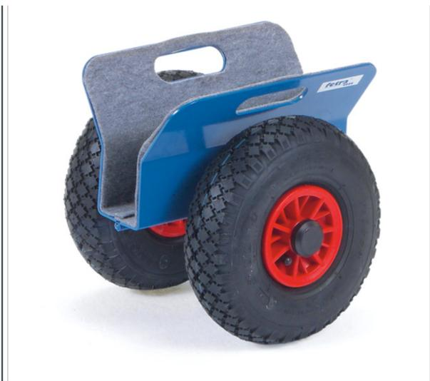
Stahl-Schweißkonstruktion, pulverbeschichtet blau RAL 5007, Klemmflächen mit Filzbelag. Sichere Klemmung durch das Gewicht des Ladegutes auf die Klappkonstruktion. Maximale Klemmbreite 0-60 mm, Gesamtbreite 305 mm.
