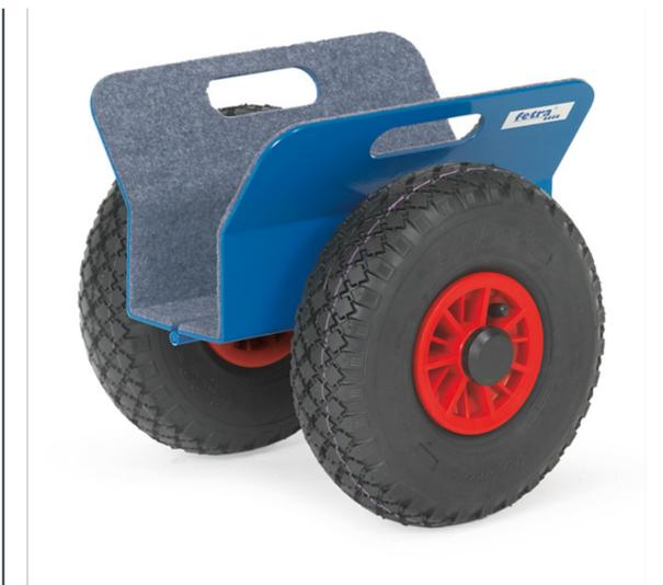
Stahl-Schweißkonstruktion, pulverbeschichtet blau RAL 5007, Klemmflächen mit Filzbelag. Sichere Klemmung durch das Gewicht des Ladegutes auf die Klappkonstruktion. Maximale Klemmbreite 30-95 mm (für Fenster geeignet). Gesamtbreite 340 mm.
