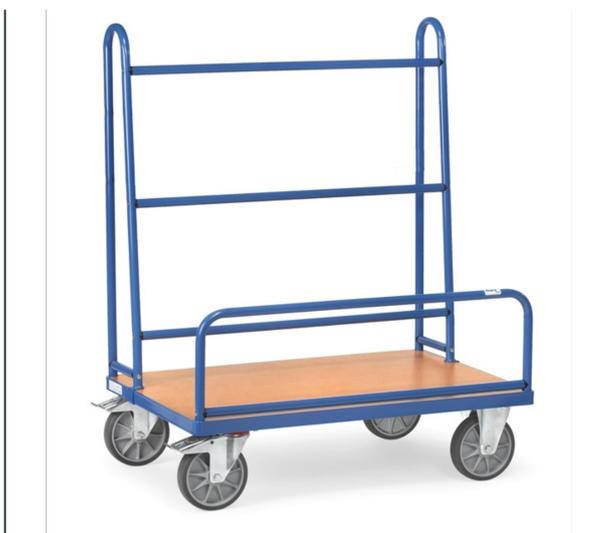
Stahlrohr- und Profilstahl geschweißt, pulverbeschichtet blau RAL 5007. Plattform Holzwerkstoffplatten, Oberfläche Buchendekor. Aufbau Stahlrohr-Konstruktion verschraubt. 2 Lenk- und 2 Bockrollen, TPE-Bereifung, 200 x 40 mm, Naben mit Rillenkugellager. Feststeller an den Lenkrollen gemäß der Europäischen Norm EN 1757-3 (Sicherheit von Plattformwagen). Anlagehöhe: 1050 mm, Haltebügelhöhe: 300 mm.
