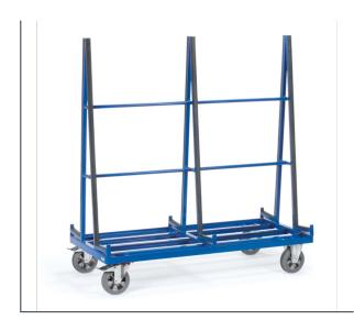
Baukasten-System: zum sicheren Transport von Glasscheiben, Holz- und Kunststoffplatten sowie kompletter Fenster und Türen. Profilstahl und Stahlrohr geschweißt. Pulverbeschichtet, blau RAL 5007. Zweiseitige Anlagen mit Profilgummi belegt. Auflagebreite 2 x 230 mm, Anlagehöhe 1450 mm. 2 Lenk- und 2 Bockrollen, Vollgummi-Elastic-Bereifung, blaugrau "spurlos", Naben mit
