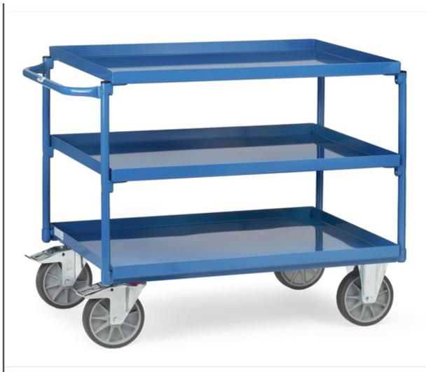
Stahlkonstruktion, geschweißt. Mit 3 Stahlblechwannen. Stahlrohnbügel und Stahlblechwannen verschraubt. Wannen öldicht, Rand 40 mm hoch. Pulverbeschichtet RAL 5007. Schiebegriff waagrecht. 2 Lenk- und 2 Bockrollen, TPE-Bereifung, Naben mit Rillenkugellager. Feststeller an den Lenkrollen, gemäß EN 1757-3 (Sicherheit von Plattformwagen). Tragkraft obere und mittlere Ladefläche 200 kg.
