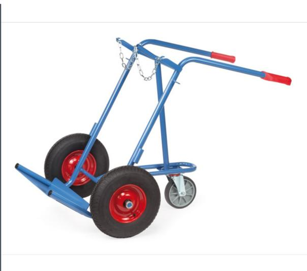
Stahlrohr geschweißt, pulverbeschichtet blau RAL 5007. Flaschenhalterungen mit Kettensicherung. Räder wahlweise mit Vollgummi- oder Luftbereifung, Naben mit Rollenlager. Schweißdrahtkocher an beiden Holmen. Zusätzlich mit 1 Stütz-Lenkrolle aus Vollgummi 200 x 50 mm.
