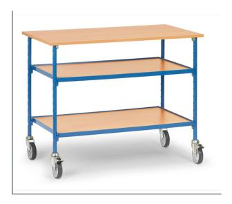
Stahlrohr und Profilstahl geschweißt, Schraubkonstruktion, pulverbeschichtet, blau RAL 5007. Tischfläche Sandwich-Platte 19 mm stark, Oberfläche Buchendekor. 2 Ablageböden im Raster von 50 mm variabel einschraubbar, 1 x Ordnerhöhe möglich. 4 Lenkrollen, TPE-Bereifung, Naben mit Gleitlager. 2 Stück mit Feststeller, gemäß der Europäischen Norm EN 1757-3 (Sicherheit von Plattformwagen). Tragkraft pro Boden 50 kg.
