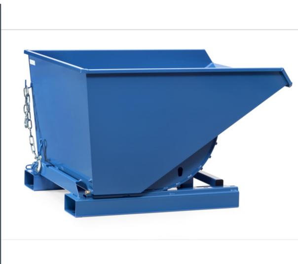
Selbstkipper müssen zum Entleeren nicht angehoben werden. Die leere Mulde geht selbsttätig in die Beladestellung zurück. Robuste Schweißkonstruktion aus 3-mm-Stahlblech, Lackierung blau RAL 5007. Serienmäßig mit Staplertaschen, Abrollsicherung und Kippverriegelung, Gliederkette als Abrutsch- und Kippsicherung. Zugseil zur Kippauslösung vom Staplersitz aus. Zusatz "A" bedeutet mit Ablasshahn und Sieb zum Trennen von Flüssigkeiten und Feststoffen.
