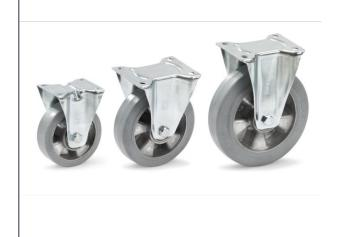
Gehäuse Stahlblech verzinkt. Räder mit Elastic-Bereifung, Reifen blaugrau, nicht kreidend (spurlos). Alu-Felgen, Naben mit Kugel lager. Leichter, elastischer Lauf, hohe Lebensdauer.
