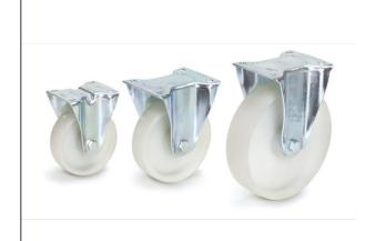
Gehäuse Stahlblech verzinkt. Räder aus Polyamid, Naben mit Rollenlager. Weitgehend beständig gegen Salzwasser, Laugen und Säuren. Hitzebeständig von ?40° bis +90° C.
