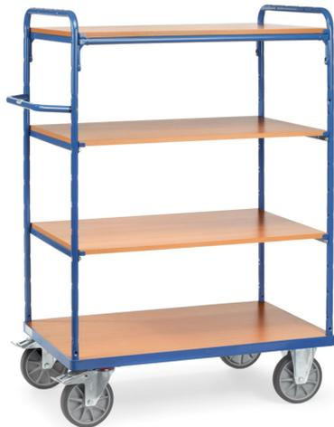
Baukasten-System: Aus Stahlrohr und Profilstahl geschweißt, pulverbeschichtet blau RAL 5007, Schraubkonstruktion. Stirnwände offen. 1 fester und 3 Einlegeböden aus Holzwerkstoffplatten, Oberfläche Buchendekor. Einlegeböden variabel einsetzbar, Teilung 100 mm. Tragkraft pro Einlegeboden 90 kg. 2 Lenk- und 2 Bockrollen, TPE-Bereifung, Naben mit Rillenkugellager. Feststeller an den Lenkrollen, gemäß der Europäischen Norm EN 1757-3 (Sicherheit von Plattformwagen).
