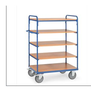
Baukasten-System: Aus Stahlrohr und Profilstahl geschweißt, pulverbeschichtet blau RAL 5007, Schraubkonstruktion. Stirnwände offen. 1 fester und 4 Einlegeböden aus Holzwerkstoffplatten, Oberfläche Buchendekor. Einlegeböden variabel einsetzbar, Teilung 100 mm. Tragkraft pro Einlegeboden 90 kg. 2 Lenk- und 2 Bockrollen, TPE-Bereifung, Naben mit Rillenkugellager. Feststeller an den Lenkrollen, gemäß der Europäischen Norm EN 1757-3 (Sicherheit von Plattformwagen).
