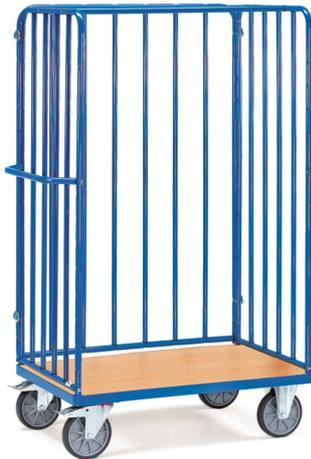
Baukasten-System, Stahlrohr und Profilstahl geschweißt, pulverbeschichtet blau RAL 5007, Schraubkonstruktion. Stirnwände mit vertikalen Rohrstreben im Abstand von ca. 130 mm. 1 Längswand zum Einhängen. Plattform Holzwerkstoffplatte, Oberfläche Buchendekor. Beräderung: 2 Lenk- und 2 Bockrollen, TPE-Bereifung, Naben mit Rillenkugellager. Feststeller an den Lenkrollen, gemäß der europäischen Norm EN 1757-3 (Sicherheit von Plattformwagen).
