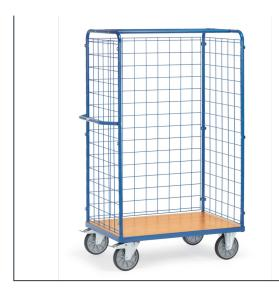
Baukasten-System, Stahlrohr und Profilstahl geschweißt, pulverbeschichtet blau RAL 5007, Schraubkonstruktion. Stirnwände und eine Längswand geschlossen mit Drahtgitter 100 x 100 x 5 mm. Plattform Holzwerkstoffplatte, Oberfläche Buchendekor. Beräderung: 2 Lenk- und 2 Bockrollen, TPE-Bereifung, Naben mit Rillenkugellager. Feststeller an den Lenkrollen, gemäß der europäischen Norm EN 1757-3 (Sicherheit von Plattformwagen).
